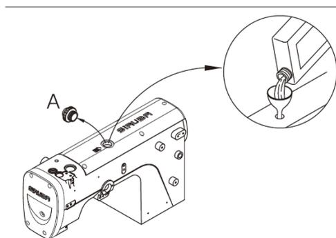
Проверяйте уровень масла каждый день и дополняйте, когда уровень станет ниже отметки low. Когда машина запущена, проверяйте – все ли хорошо функционирует. Смазывайте верхнюю и нижнюю часть игловодителя у новой машины или машины, которой долго не пользовались.
