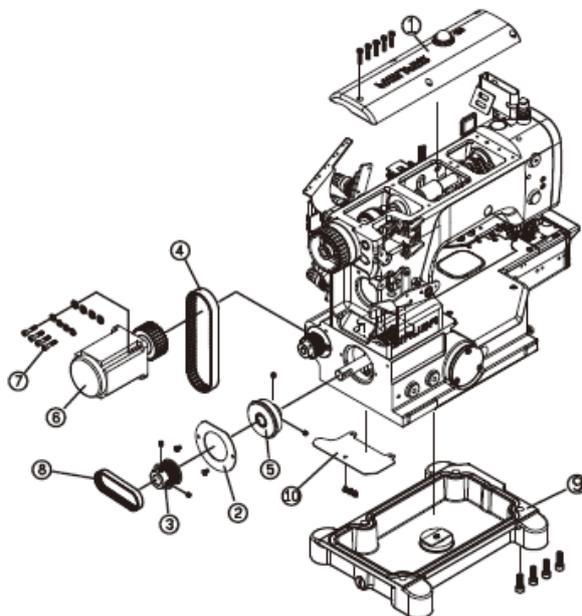
3. Оденьте ремень (4) на шкиф. Держите верхнюю часть ремня (4) инструментом и поворачивайте шкиф (10) для того, чтобы соединить ремень с шестерней и двигателем 6, поворачивайте плавно. Закрепите двигатель на корпусе машины с помощью винтов (7).
