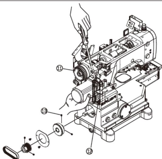
5. Закрутите подшипник 5 и шкиф 3 в оригинальную позицию. Затем закрепите левый шкиф 14.
