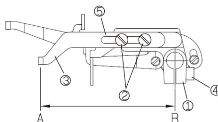
Ослабьте винт 2 для регулировки длины между точкой А и В, расстояние должно быть 75мм, затем затяните винт. Для того, чтобы ослабить игольную нить, поверните нитепритягиватель 3 влево. Для натяжения игольной нити, поверните нитенатяжитель 3 вправо.
