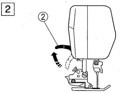
2 Поднимите рычаг прижимной лапки и саму лапку.
