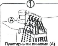
Пунктирными линиями (А обозначена эластичная нить. Сплошной линией обозначена стандартная нить.
